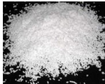
溶液的 pH 约为 14，相对密度 1.51，熔点  $471^{\circ}\text{C}$ （无水），沸点  $925^{\circ}\text{C}$ （分解）。
